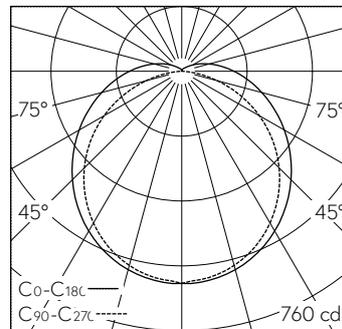
LED 4000 K 20 W 2178 lm-h 130°/110° / CIE Flux 42 71 89 92 100 / A31 selon DIN 5...
