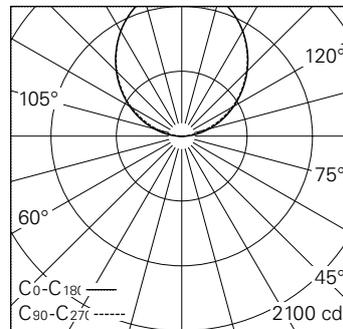
LED 2700 K 48,4 W 4390 lm-h / CIE Flux 0 0 12 1 100 / E03 selon DIN 5040
