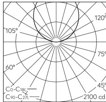
LED 4000 K 48,4 W 4870 lm-h / CIE Flux 0 0 12 1 100 / E03 selon DIN 5040
