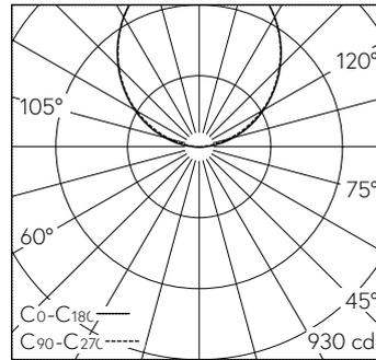
LED 2700 K 24,2 W 2195 lm-h / CIE Flux 0 0 12 1 100 / E03 selon DIN 5040
