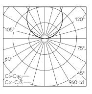
LED 3000 K 24,2 W 2235 lm-h / CIE Flux 0 0 12 1 100 / E03 selon DIN 5040
