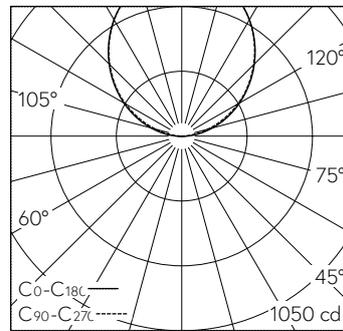
LED 4000 K 24,2 W 2435 lm-h / CIE Flux 0 0 12 1 100 / E03 selon DIN 5040
