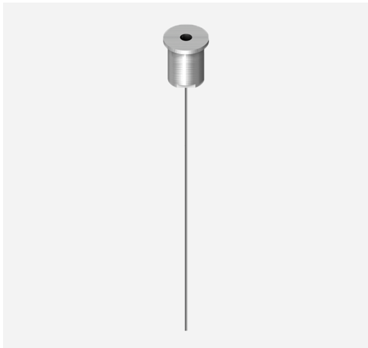
Fixation plafond cylindrique nickelée. Câble d'acier Ø1.5, L3000, réglage de hauteur sans outil.
