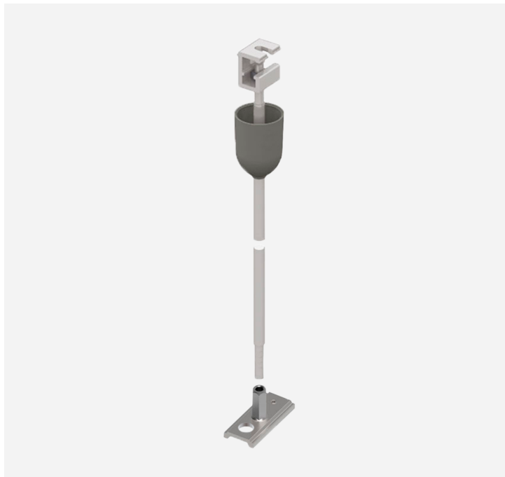
Bride pour fixation au plafond en métal. Baldaquin en plastique, noir. Tube et étrier de fixation avec borne M6.
