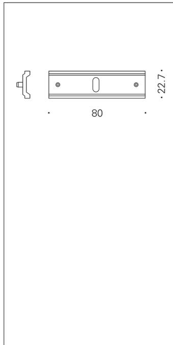
Clip rail conductrice pour câble Ø1.5.
