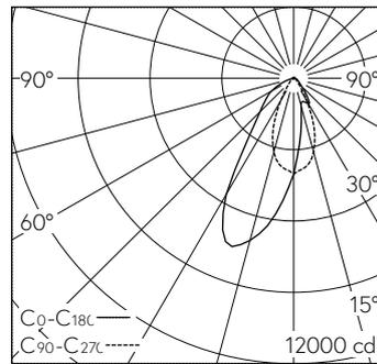
LED 4000 K 33 W 5500 lm-h / CIE Flux 69 90 98 98 100 / A62 selon DIN 5040
