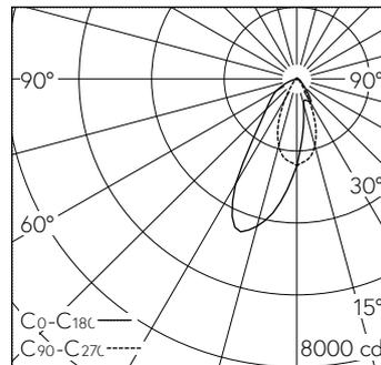
LED 4000 K 20 W 3300 lm-h / CIE Flux 69 90 98 98 100 / A62 selon DIN 5040
