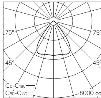
LED 4000 K 39 W 5800 lm-h / CIE Flux 85 96 99 98 100 / A71 selon DIN 5040
