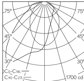
LED 4000 K 20 W 2300 lm-h / CIE Flux 51 81 95 100 100 / A40 selon DIN 5040
