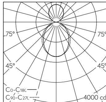
LED 4000 K 221 W 25000 lm-h / CIE Flux 53 83 97 64 100 / B43 selon DIN 5040
