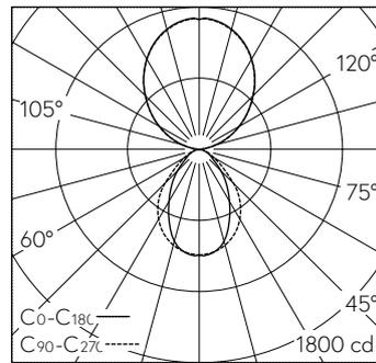
LED 4000 K 37 W 4300 lm-h / CIE Flux 67 91 98 35 100 / D63 selon DIN 5040
