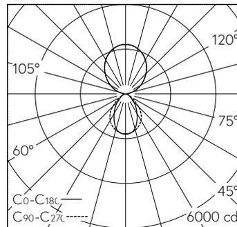
LED 4000 K 74 W 8600 lm-h / CIE Flux 67 91 98 35 100 / D63 selon DIN 5040
