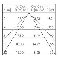
LED 4000 K 47 W 5800 lm-h 64°/86° / CIE Flux 68 91 98 100 100 / A60 selon DIN 5...
