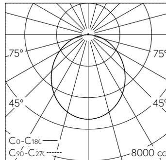
LED 4000 K 91 W 14400 lm-h / CIE Flux 49 79 95 99 100 / A44 selon DIN 5040
