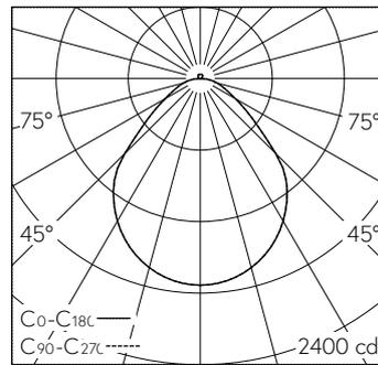
LED 4000 K 25 W 3800 lm-h / CIE Flux 60 87 97 97 100 / A53 selon DIN 5040
