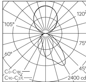
LED 4000 K 54 W 6300 lm-h / CIE Flux 52 82 96 45 100 / C43 selon DIN 5040
