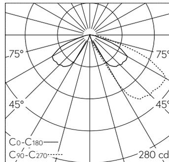
LED 3000 K 7 W 320 lm-h / CIE Flux 23 66 95 99 100 / A10 selon DIN 5040
