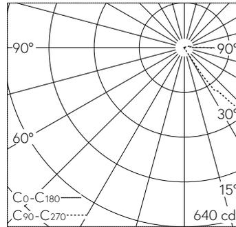
LED 4000 K 5.4 W 438 lm-h / CIE Flux 6 40 79 98 100 / A10 selon DIN 5040
