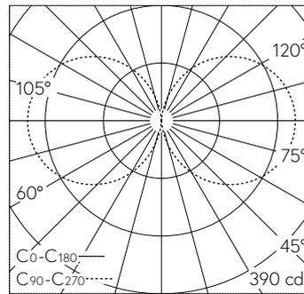
LED 4000 K 27 W 1731 lm-h 102°/66° / CIE Flux 13 37 66 50 100 / C11 selon DIN 5040
