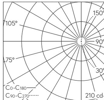
LED 3000 K 14 W 817 lm-h / CIE Flux 13 37 66 50 100 / C11 selon DIN 5040
