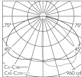
LED 3000 K 18.5 W 1875 lm-h / CIE Flux 42 77 96 100 100 / A30 selon DIN 5040
