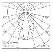
LED 3000 K 53 W 3657 lm-h / CIE Flux 58 88 99 100 100 / A50 selon DIN 5040
