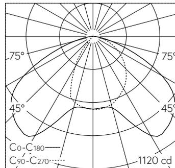
LED 3000 K 43 W 5228 lm-h / CIE Flux 41 79 97 100 100 / A30 selon DIN 5040
