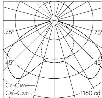
LED 4000 K 21.5 W 2694 lm-h / CIE Flux 41 79 97 100 100 / A30 selon DIN 5040
