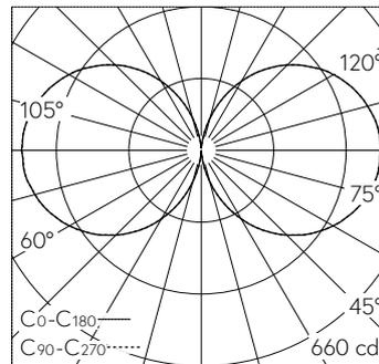
LED 4000 K 51 W 6043 lm-h / CIE Flux 13 37 66 50 100 / C11 selon DIN 5040
