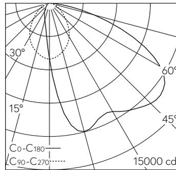
LED 4000 K 190 W 17807 lm-h / CIE Flux 46 78 96 100 100 / A40 selon DIN 5040
