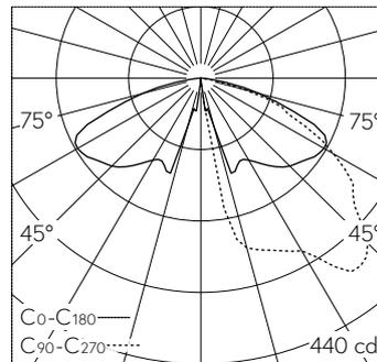
LED 3000 K 7 W 665 lm-h / CIE Flux 32 71 95 100 100 / A20 selon DIN 5040
