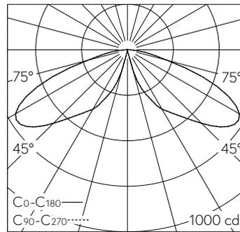
LED 4000 K 22.5 W 2442 lm-h 144° / CIE Flux 21 63 94 100 100 / A10 selon DIN 5040
