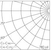
LED 3000 K 14 W 1321 lm-h / CIE Flux 4 34 75 97 100 / A10 selon DIN 5040
