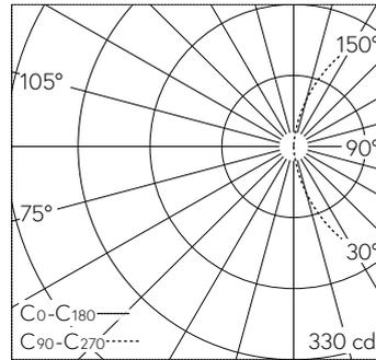
LED 4000 K 14 W 1146 lm-h / CIE Flux 13 37 66 50 100 / C11 selon DIN 5040
