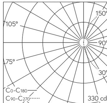
LED 3000 K 14 W 1146 lm-h / CIE Flux 13 37 66 50 100 / C11 selon DIN 5040
