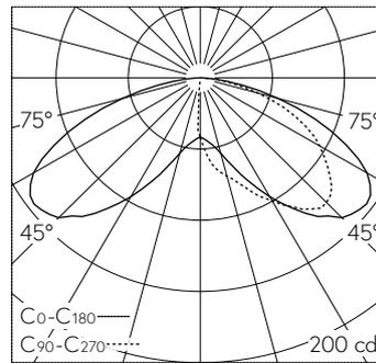
LED 3000 K 5 W 371 lm-h / CIE Flux 28 69 94 100 100 / A20 selon DIN 5040
