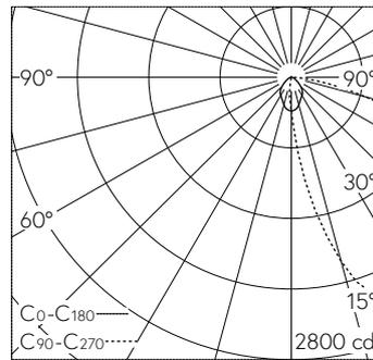
LED 4000 K 53.2 W 5812 lm-h / CIE Flux 42 80 97 100 100 / A30 selon DIN 5040
