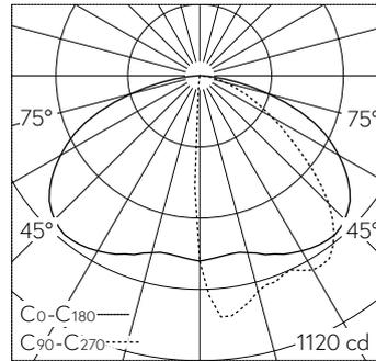
LED 4000 K 18 W 1951 lm-h / CIE Flux 43 77 96 100 100 / A30 selon DIN 5040
