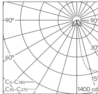
LED 4000 K 13.7 W 1893 lm-h / CIE Flux 37 76 95 100 100 / A30 selon DIN 5040
