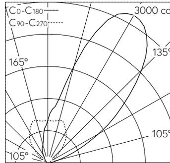
LED 3000 K 30.5 W 3365 lm-h / CIE Flux 0 0 0 100 / E84 selon DIN 5040
