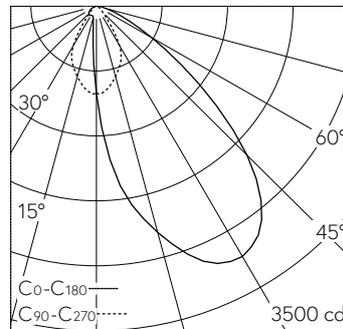
LED O K 45 W 2239 lm-h / CIE Flux 69 95 99 100 100 / A60 selon DIN 5040
