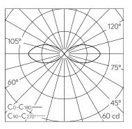
LED 3000 K 5 W 190 lm-h / CIE Flux 1 17 50 50 100 / C11 selon DIN 5040
