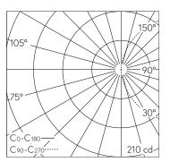
LED 3000 K 11 W 743 lm-h / CIE Flux 13 37 66 50 100 / C11 selon DIN 5040
