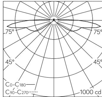
LED 4000 K 22.5 W 1654 lm-h / CIE Flux 0 12 46 88 100 / B01 selon DIN 5040
