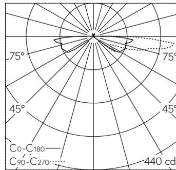
LED 3000 K 13.8 W 604 lm-h / CIE Flux 0 8 34 92 100 / A01 selon DIN 5040
