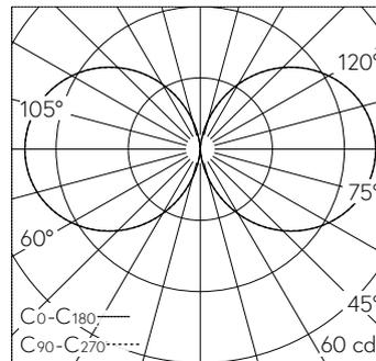
LED 3000 K 5 W 463 lm-h / CIE Flux 13 37 66 50 100 / C11 selon DIN 5040
