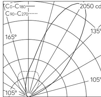
LED 3000 K 18 W 1729 lm-h / CIE Flux 0 0 0 100 / E84 selon DIN 5040
