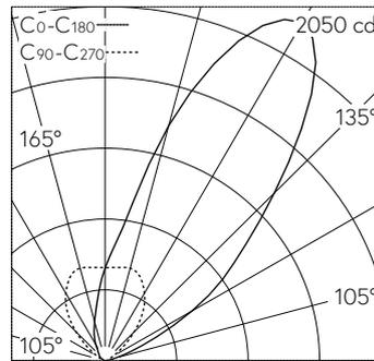
LED 3000 K 18 W 1705 lm-h / CIE Flux 0 0 0 100 / E84 selon DIN 5040
