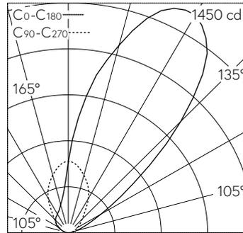
LED 4000 K 18.7 W 1637 lm-h / CIE Flux 0 O 25 0 100 / E84 selon DIN 5040
