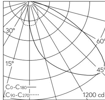
LED 3000 K 13 W 1339 lm-h / CIE Flux 44 83 98 100 100 / A40 selon DIN 5040
